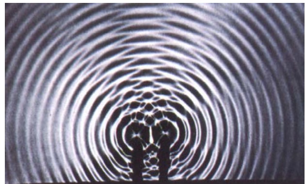
Interferencias producidas en agua por ondas que provienen de focos diferentes.
